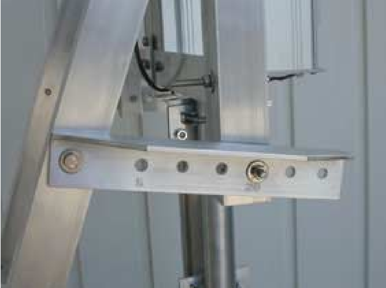
Justering av panelvinkel mellom 5 til 30 grader
